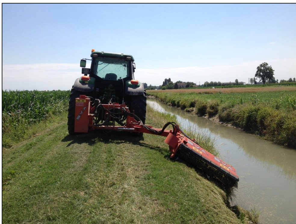
Fig. 2.18 – Sfalcio della vegetazione spondale
