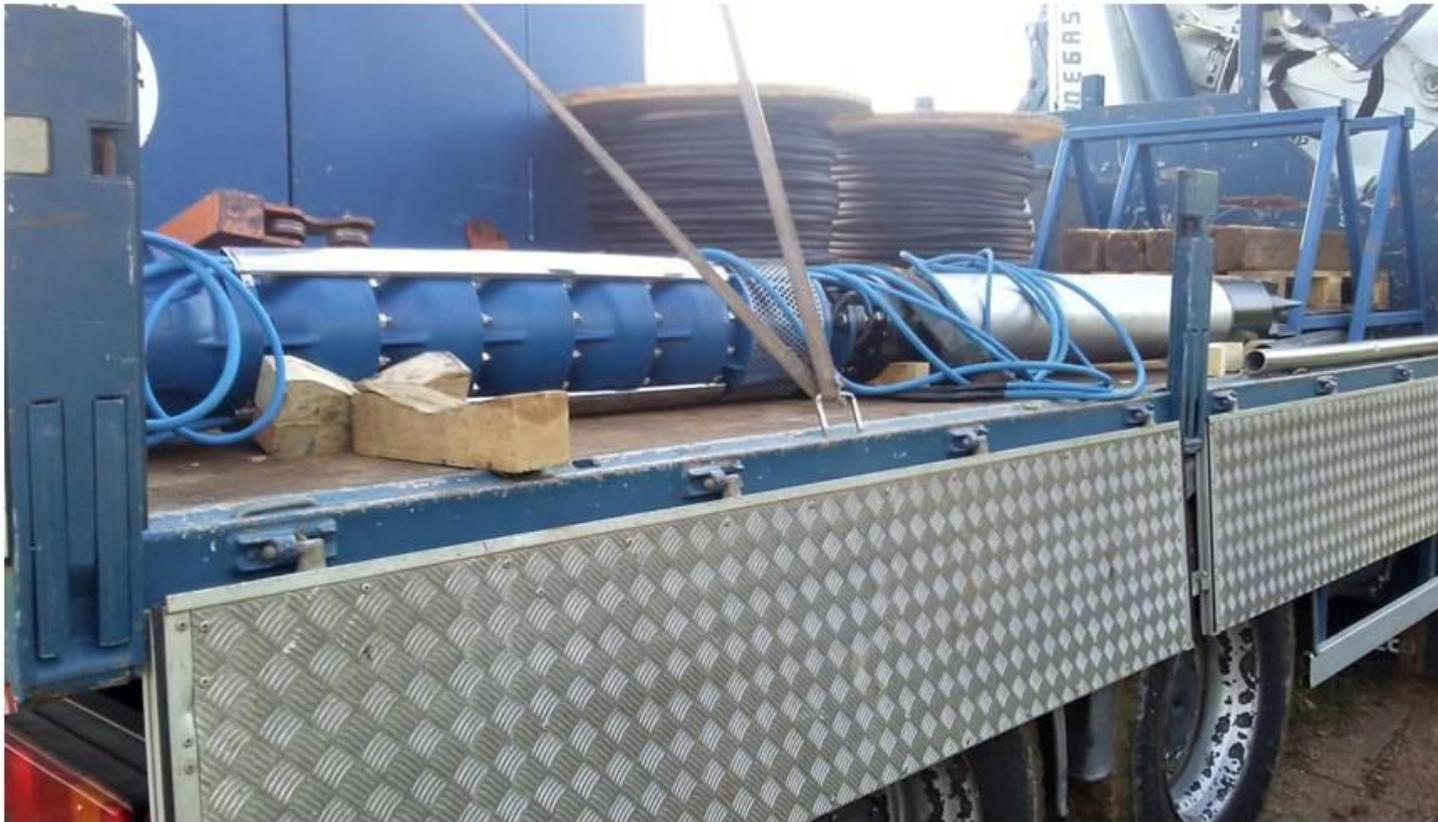
Sostituzione pompa elettrosommersa centrale Vaibò
