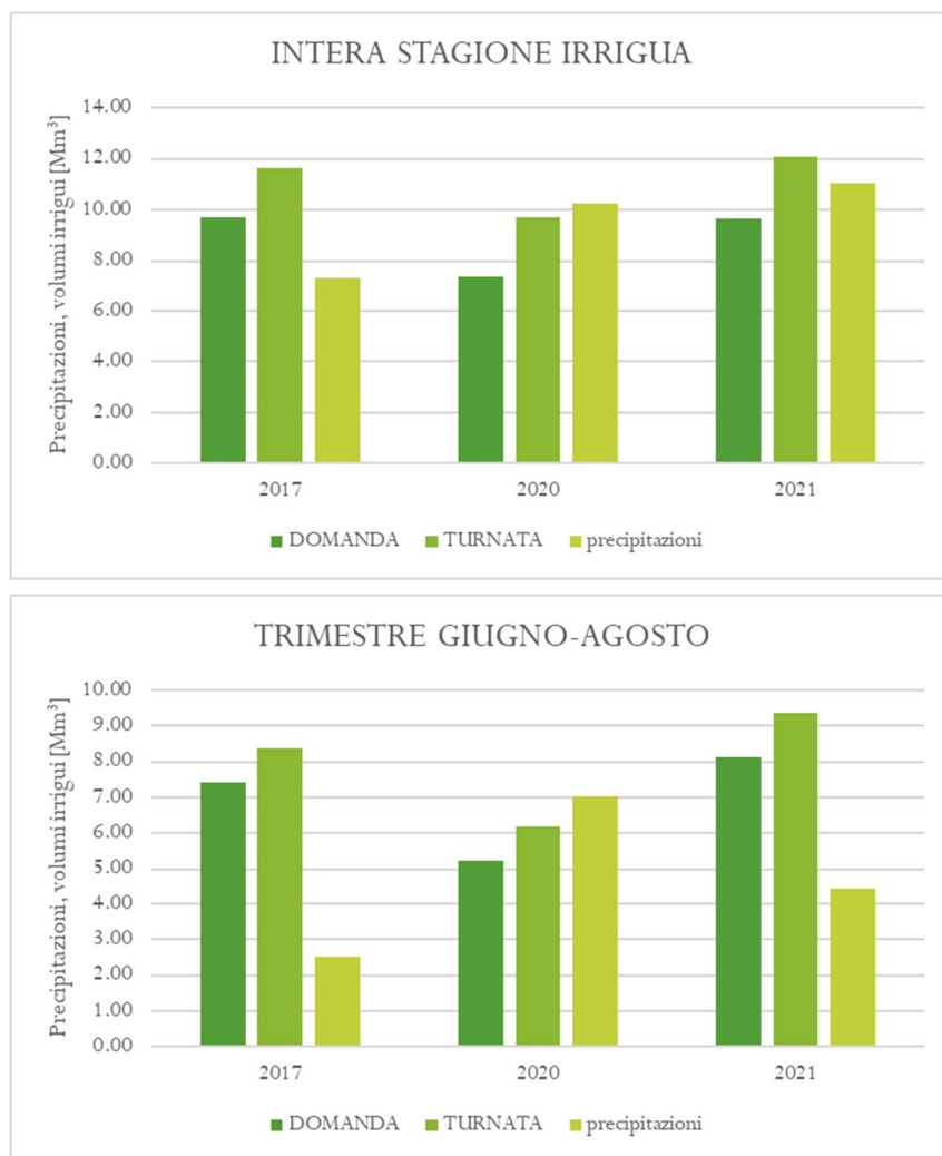
FIGURA 9. CONFRONTO TRA I VOLUMI IRRIGUI UTILIZZATI DURANTE L'INTERA STAGIONE (A) E DURANTE I MESI DI MAGGIORE RICHIESTA (B) [Mm³] STIMATI NEL CASO DI DISTRIBUZIONE TURNATA E A DOMANDA PER GLI ANNI 2017, 2020 E 2021, RISPETTIVAMENTE CARATTERIZZATI DA PRECIPITAZIONI SCARSE, ABBONDANTI E NELLA MEDIA.
