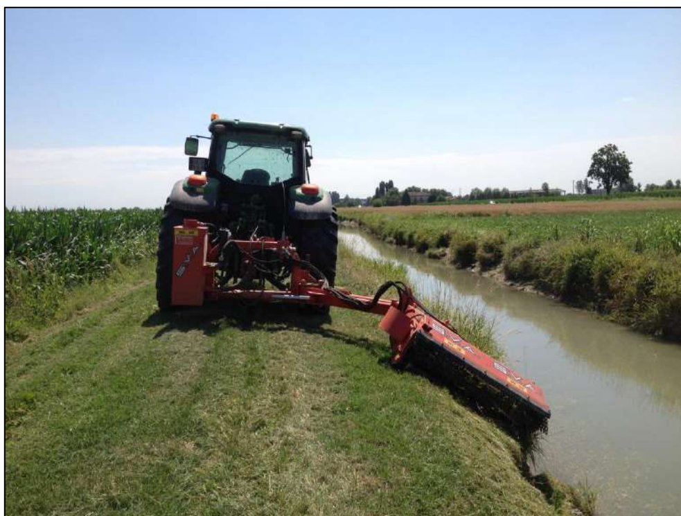
Fig. 2.18 – Sfalcio della vegetazione spondale
